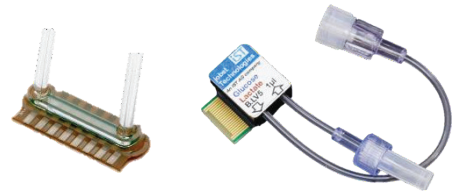
루어 또는 튜브 커넥터의 Glucose 및 Lactate 0.1 \mu l/min ~ 60 ml/min의 유량에 적합한 다양한 유량 바이오센서 어셈블리
